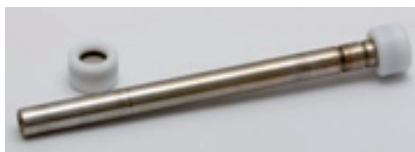
Příklady pasivních vzorkovačů vzduchu a dozimetrů. Foto: Marie Benešová
