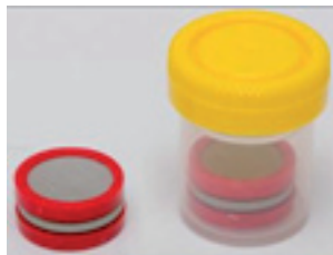
Příklady pasivních vzorkovačů vzduchu a dozimetrů. Foto: Marie Benešová
